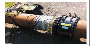
Les ondes guidées générées dans le matériau se propagent entre les parois de la pièce à contrôler.
