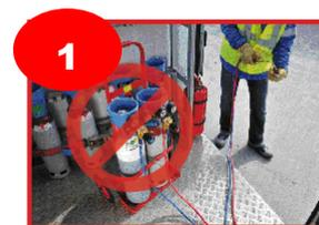
Ne pas laisser votre poste de soudure à l'intérieur du véhicule lors de travaux.
